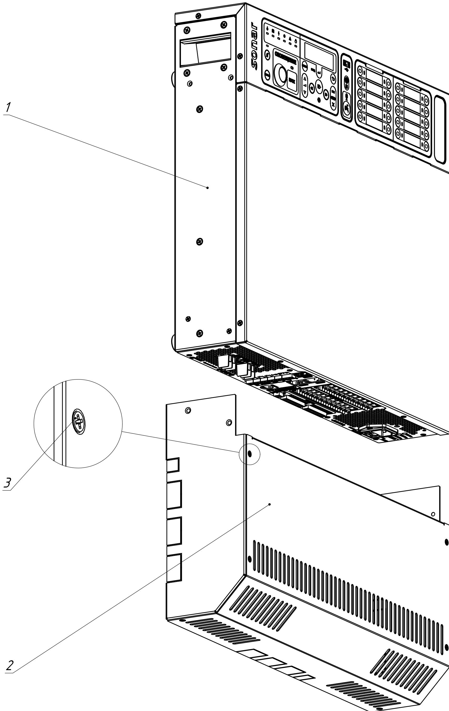
1) Снять крышку кожуха (поз. 2), открутив винты (поз. 3) (6 шт.).
