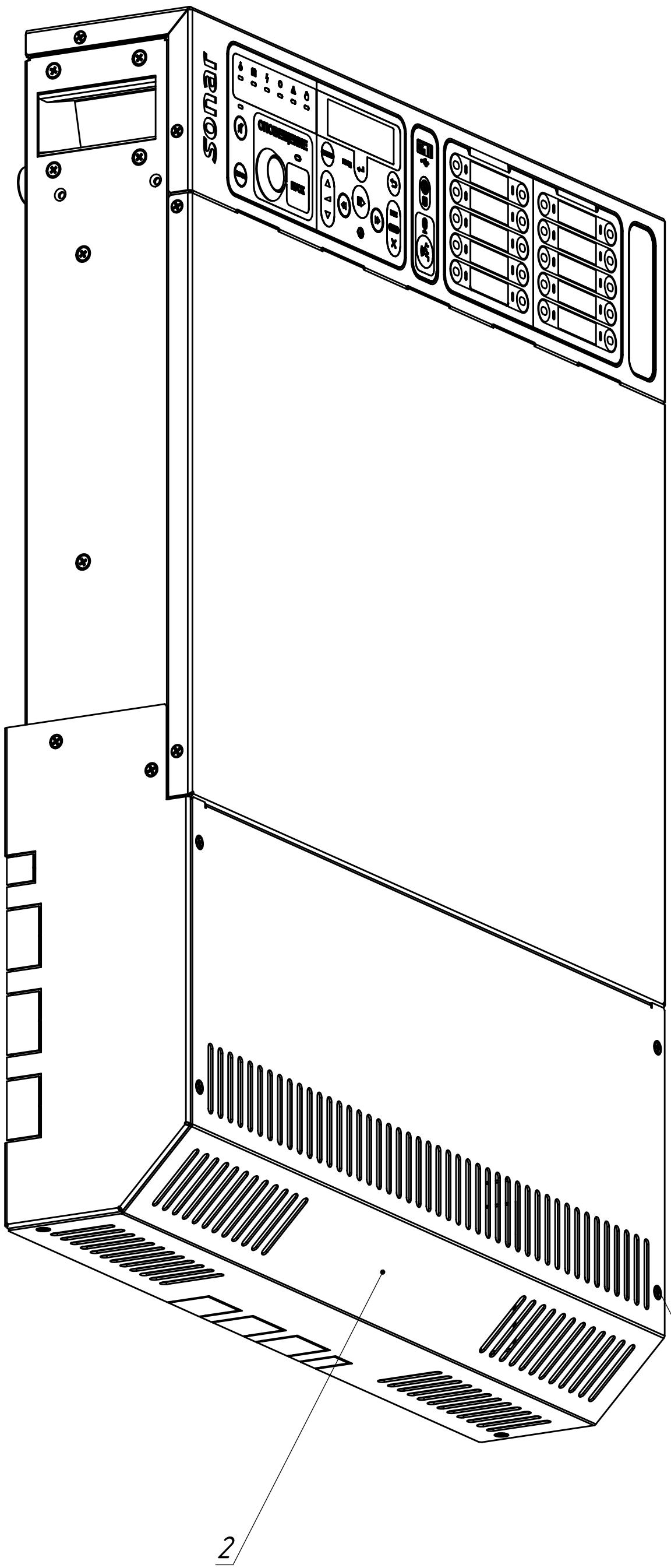
6) Поставить (снятую в п.1) панель кожуха (поз.2) на место, закрутить винты (поз.3) (6 шт.).
