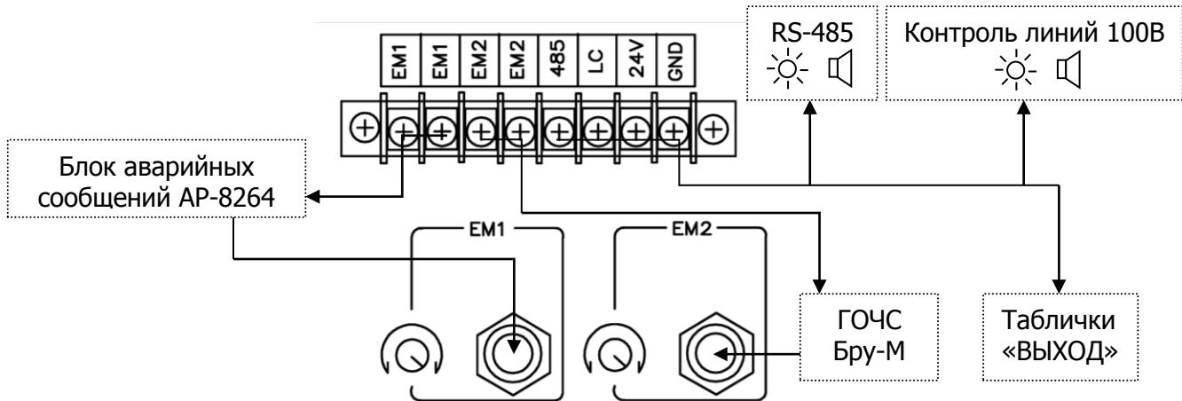
При такой схеме включения, в случае поступления на клеммы 1-8 EMERGENCY INPUT (поз. 20) аварийного сигнала от системы ОПС, подключаются соответствующие зоны, активируется модуль речевых сообщений, и в выбранные зоны через AUDIO вход EM1, поступает записанное сообщение.
