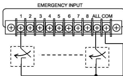
При замыкании клеммы 1-8, и клеммы СОМ включаются соответствующие зоны, индикаторы зон CH1-CH8 (поз.4) загораются красным цветом. Сигнал со входа EM1 поступает на усилитель мощности, при этом основной регулятор громкости VOLUME (поз.7) блокируется, регулировка громкости становится возможной только при помощи регулятора EM1 (поз.16)).
